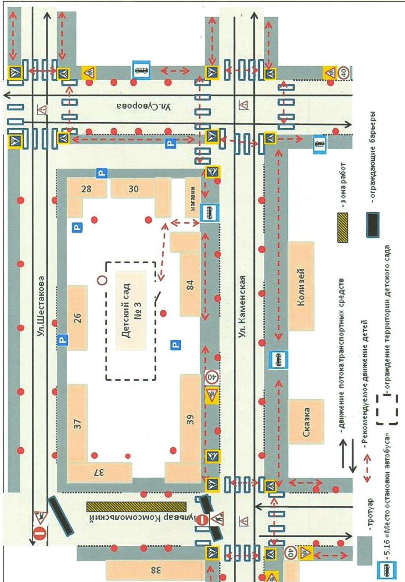
1 План-схема пути движения транспортных средств и детей при проведении дорожных ремонтно-строительных работ вблизи образовательной организации (3)
